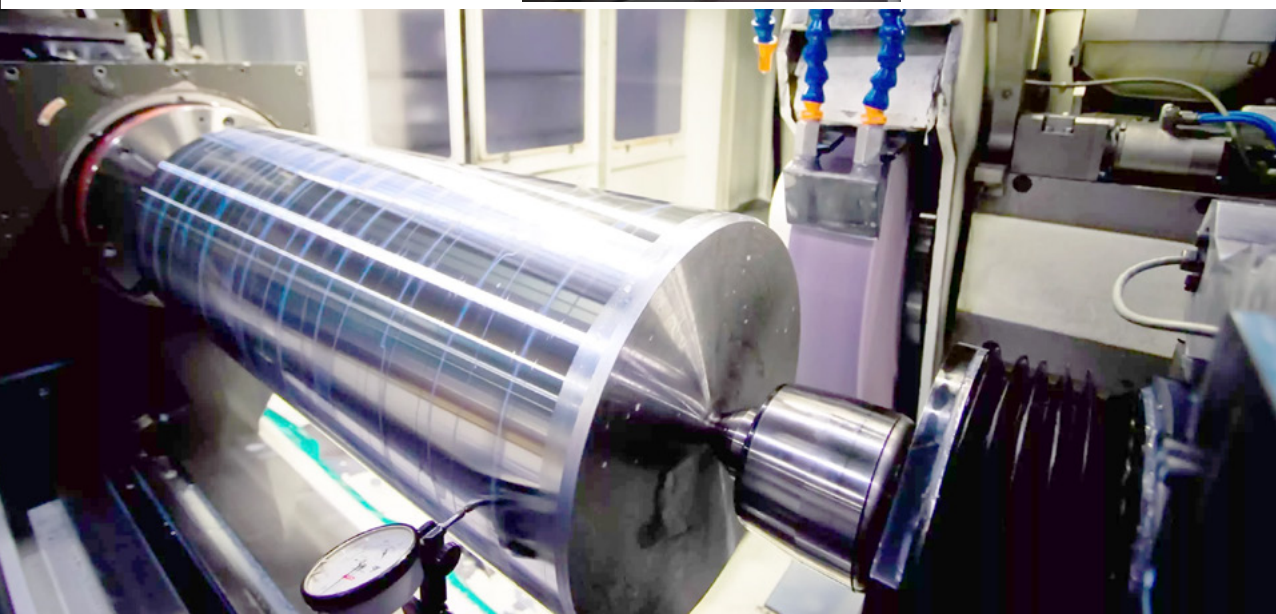
unten: Rundsleifen nach exakten Maßtoleranzen und Oberflächengüten
